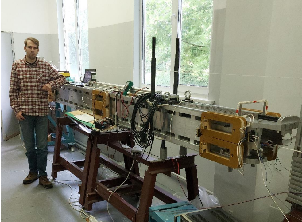
Я. И. Горбачёв проводит измерения и настройку ОПП перед установкой на Новосибирский ЛСЭ.
