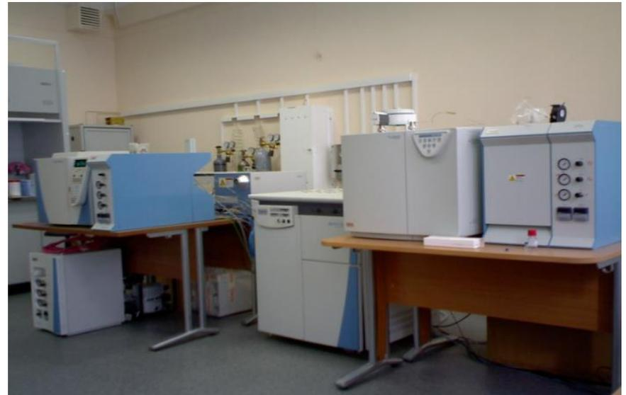
Delta V Plus, сопряжённый с газовым хроматографом Trace GC Ultra или с элементарным анализатором Flash EA 1112
