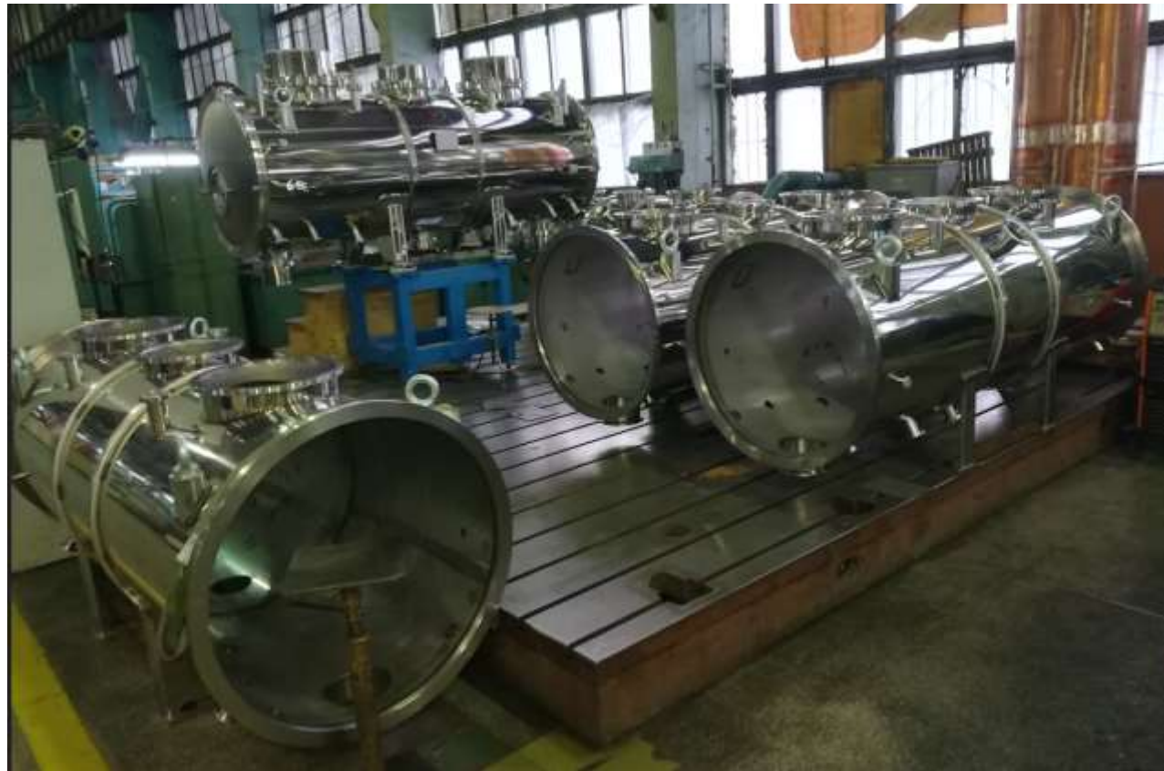
Криостаты вигглеров и ондуляторов СКИФ в ИЯФ СО РАН
