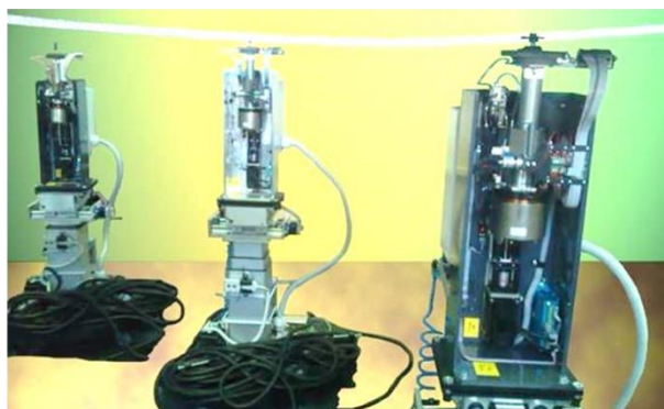
Фрагмент системы обезвешивания при проведении модальных испытаний.
