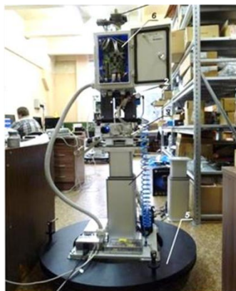
Внешний вид единичной стойки системы обезвешивания и проведения модальных испытаний (в системе 16 таких стоек).
