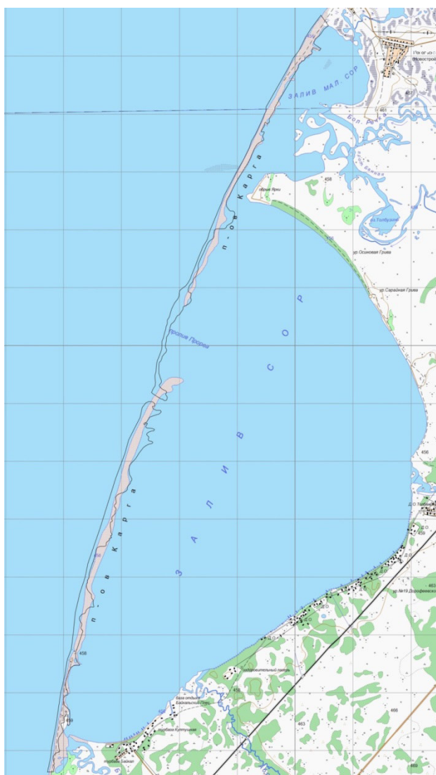
Рисунок 1.1.13 – Топографическая карта района залива Сор 1:50000 масштаба, составленная по материалам съемки 2011 г. Черной ломаной линией путем наложения показан контур полуострова Карга с карты, созданной по материалам геодезической съемки 1942 г.
