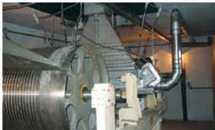
Устройство выпуска пучка, оборудованная 4-х сторонней системой облучения и под-пучковой системой
