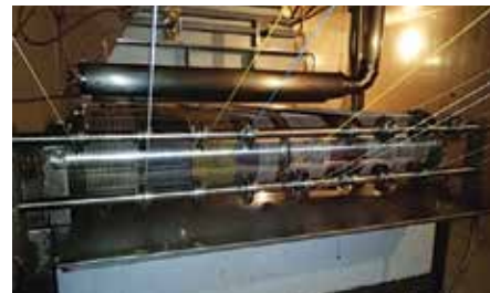
Обработка проводов на заводе компании Woer Company (Китай) по системе «8 входов – 8 выходов». Скорость каждой линии – до 300 м/мин
