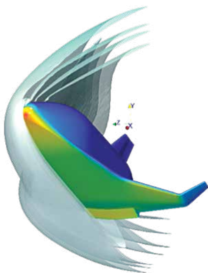
Изоповерхности плотности и распределение давления по поверхности космического аппарата «Клипер» при входе в верхние слои атмосферы
