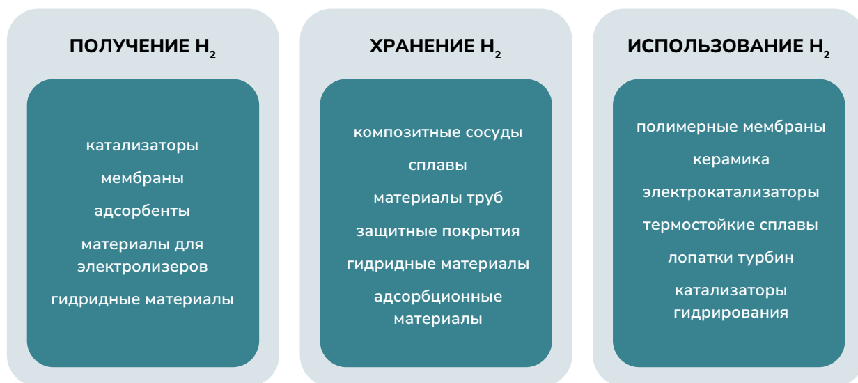
Рис. 2. Основные типы материалов, применяемых для получения, хранения и использования водорода
