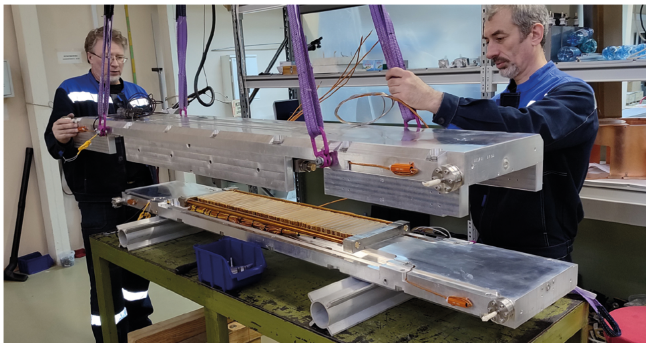
Рис. 10. Процесс сборки магнитной системы сверхпроводящего вигглера с полем 4.5 Тл для СКИФ
