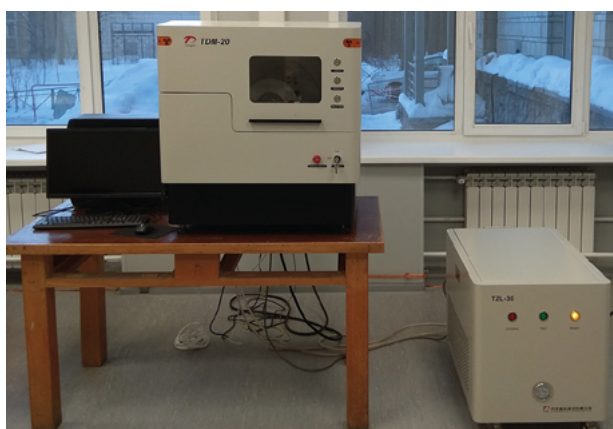
Рис. 1. Порошковые рентгеновские дифрактометры для межфакультетского практикума по рентгеновским и синхротронным методам исследования
