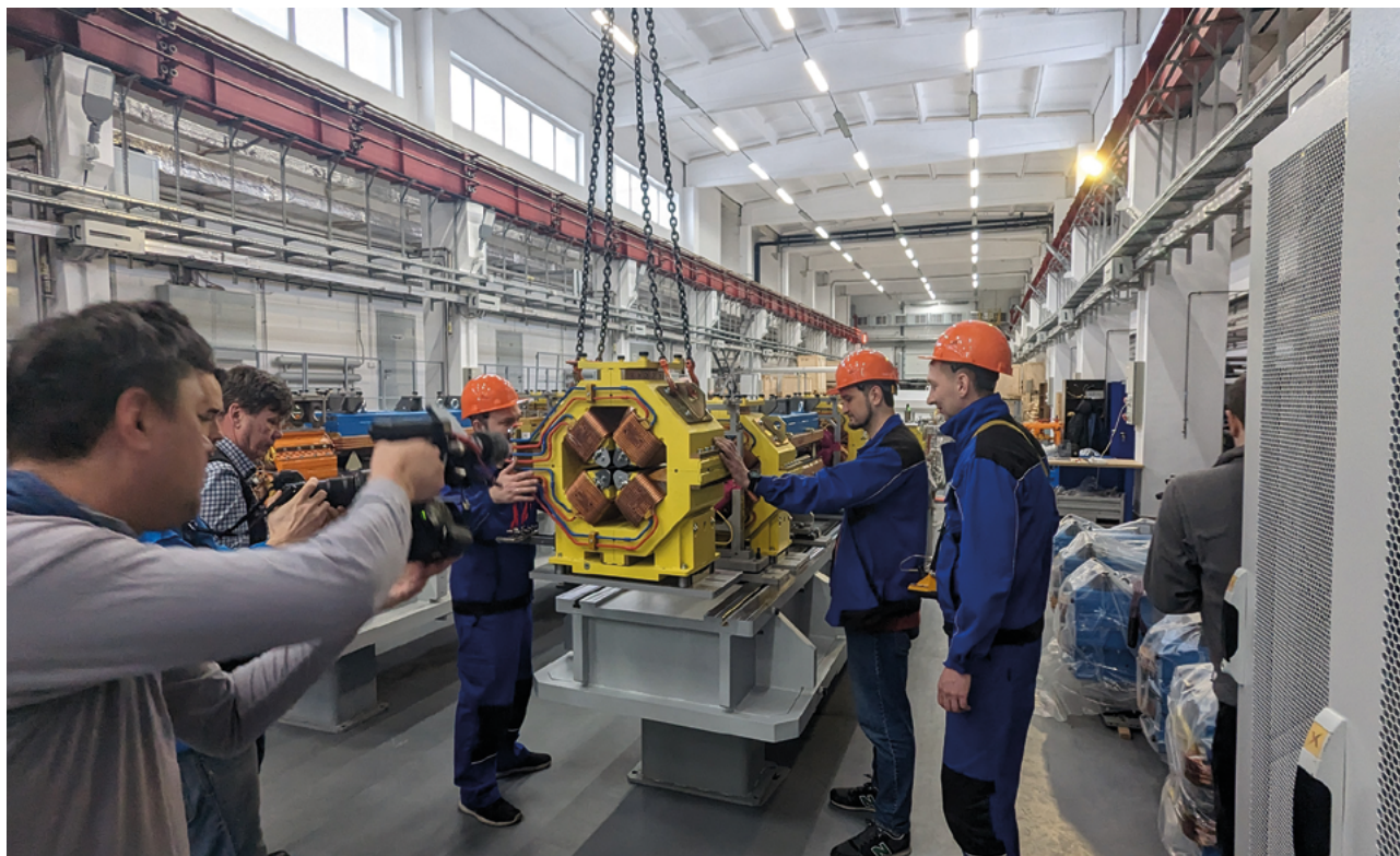
Начало компоновки магнитной системы накопительного кольца СКИФ (февраль 2024)
