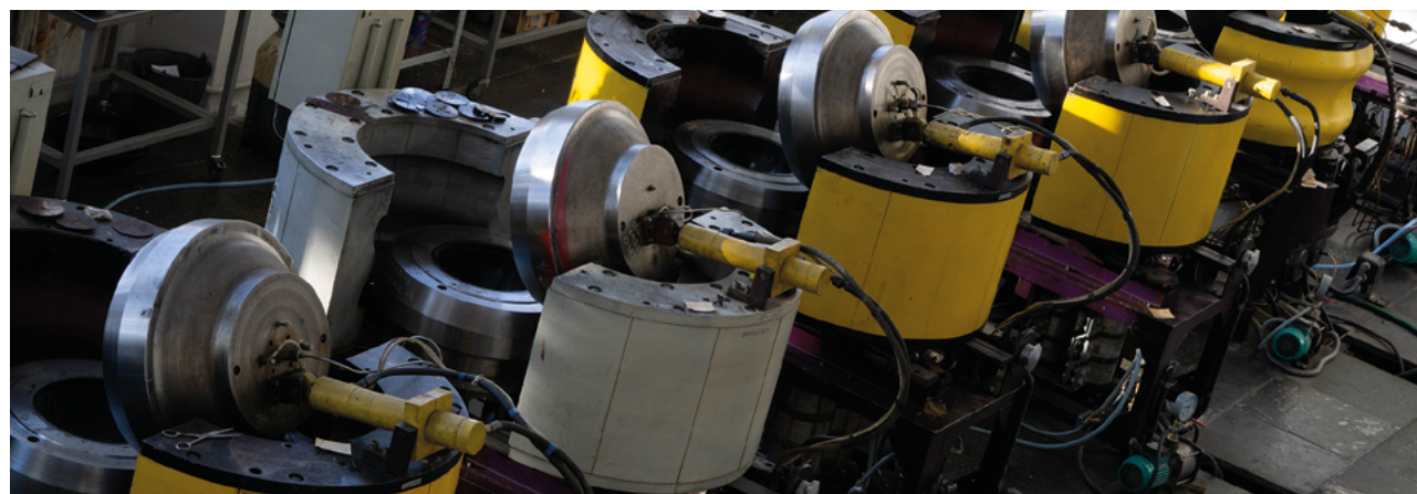
Беспроводные аппараты «разрезная сфера» (БАРС) — разработка Института геологии и минералогии им. В. С. Соболева СО РАН — позволяют выращивать крупные высококачественные монокристаллы алмаза, необходимые для изготовления алмазных окон для фронтендов ЦКП «СКИФ» (январь 2023)
