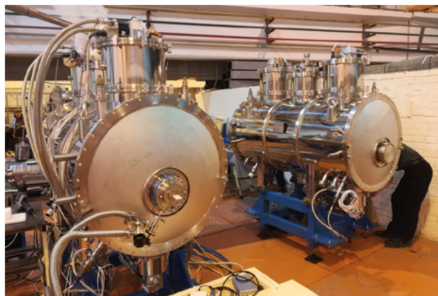
Рис. 8. Внешний вид двух сверхпроводящих вигглеров косвенного охлаждения, созданных ИЯФ СО РАН для Курчатовского источника СИ (г. Москва)
