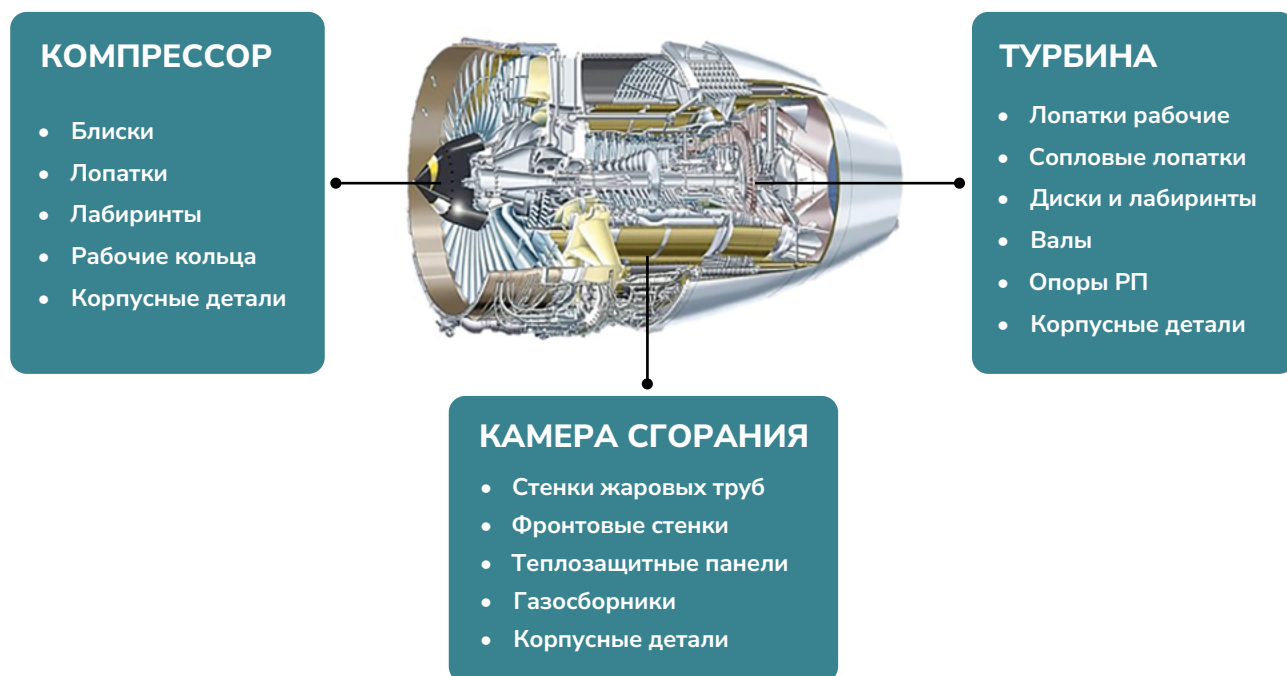
Рис. 1. Области применения ремонта узлов ГТД с помощью аддитивного лазерного выращивания (согласно ОДК «Авиадвигатель»)
