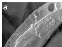
Поперечное сечение стенки и фрагменты поверхности исходных ценосфер с SiO 2 /Al 2 O 3 = 3,2 (а) и микросфер, содержащих фазу NaP1 (б,в)
