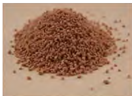
Укрупненная партия цеолитного сорбента NaP1: емкость по Cs + – до 200 мг/г; по Sr 2+ – до 60 мг/г
