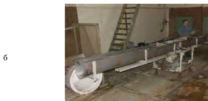
Вибролотковый просеиватель для ситового разделения
