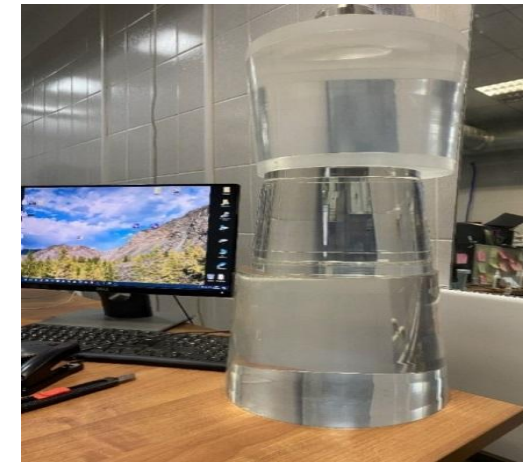
Пример изделия из прозрачного сверхвысокомолекулярного полиметилметакрилата большого размера
