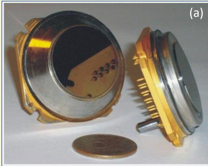
Общий вид микроболометрической головки (а) и тепловизионной камеры (б)
